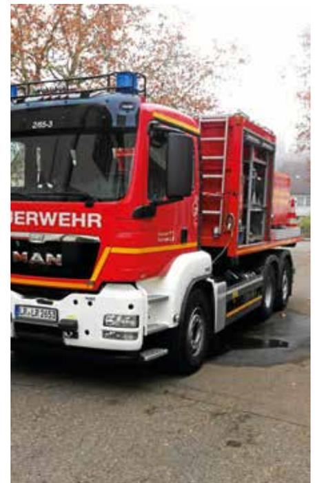
Der Wechselader 3 der Feuerwehr Stadt Lahr, beladen mit dem Abrollbehälter Wasser/Schaum der Feuerwehr Kehl
