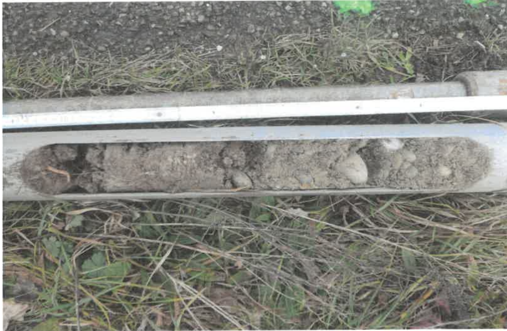
Bild 17: Kleinbohrung bei LK-4 von 1,00 bis 1,50 m Tiefe
