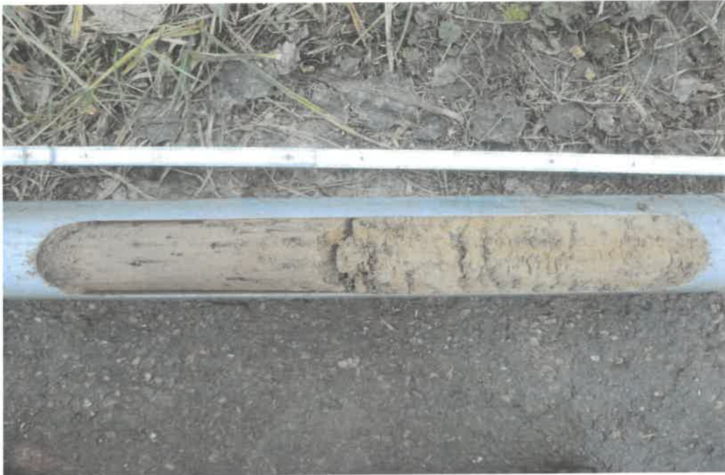
Bild 25: Kleinbohrung bei LK-6 von 0,50 m bis 1,00 m Tiefe
