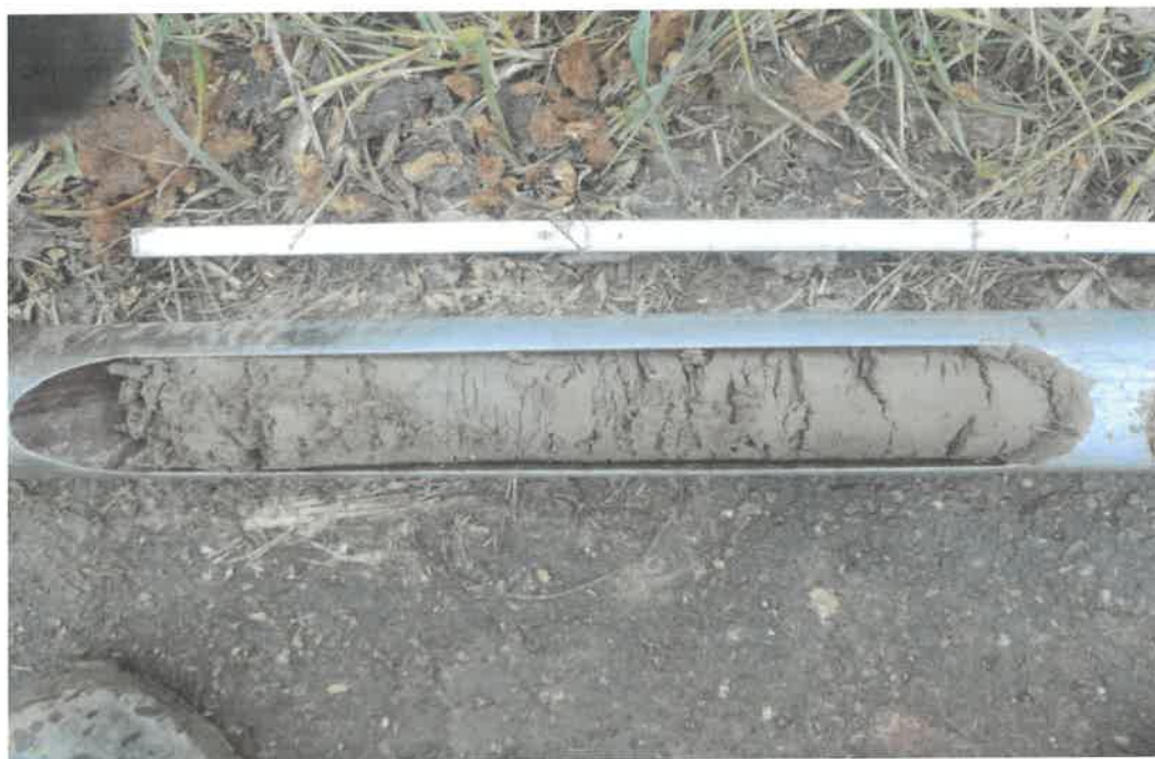
Bild 24: Kleinbohrung bei LK-6 von 0,0 bis 0,50 m Tiefe
