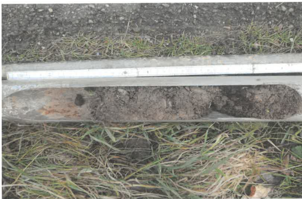
Bild 16: Kleinbohrung bei LK-4 von 0,0 bis 1,00 m Tiefe
