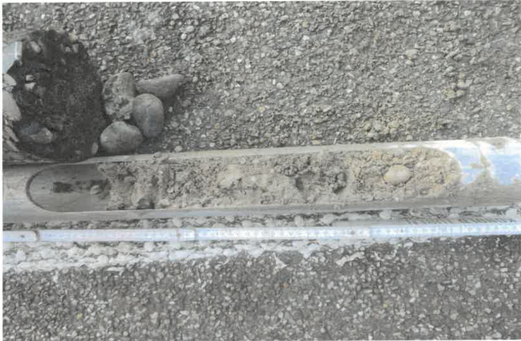
Bild 9: Kleinbohrung bei LK-2 von 0,30 bis 1,00 m Tiefe
