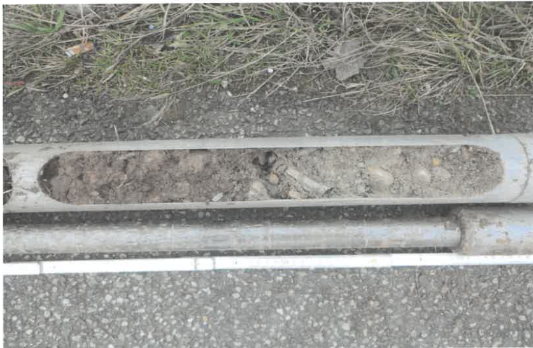
Bild 21: Kleinbohrung bei LK-5 von 0,30 bis 1,20 m Tiefe
