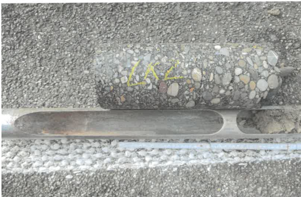
Bild 8: Kleinbohrung bei LK-2 von 0,0 bis 0,30 m Tiefe
