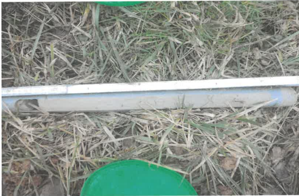
Bild 27: Kleinbohrung bei LK-6 von 1,50 bis 2,00 m Tiefe
