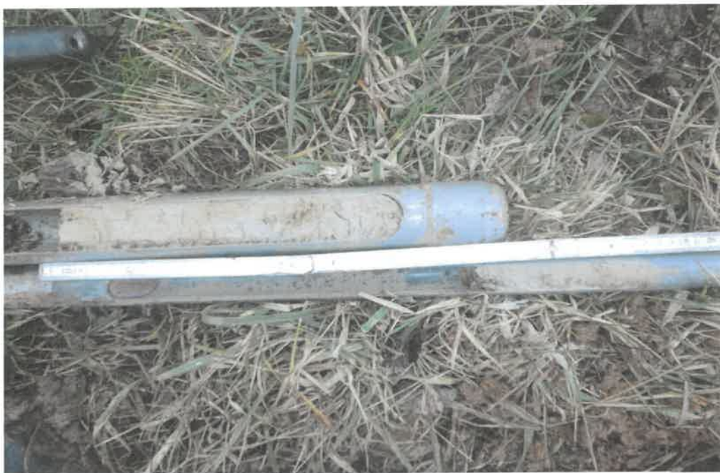
Bild 26: Kleinbohrung bei LK-6 von 1,00 bis 1,50 m Tiefe
