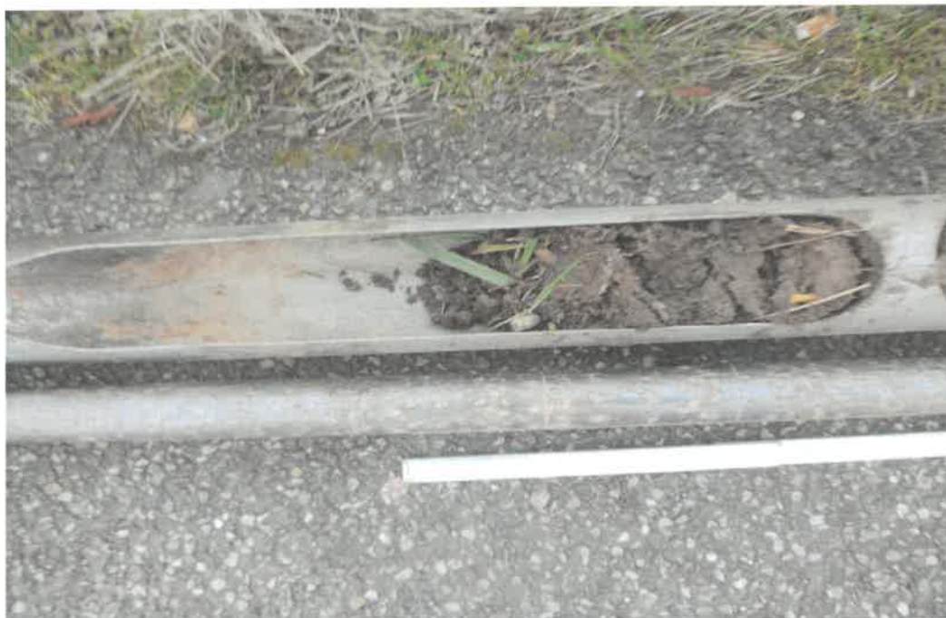
Bild 20: Kleinbohrung bei LK-5 von 0,0 bis 0,30 m Tiefe
