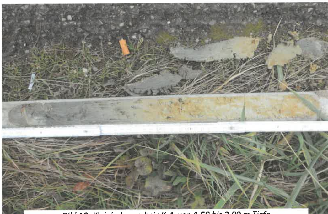
Bild 18: Kleinbohrung bei LK-4 von 1,50 bis 2,00 m Tiefe
